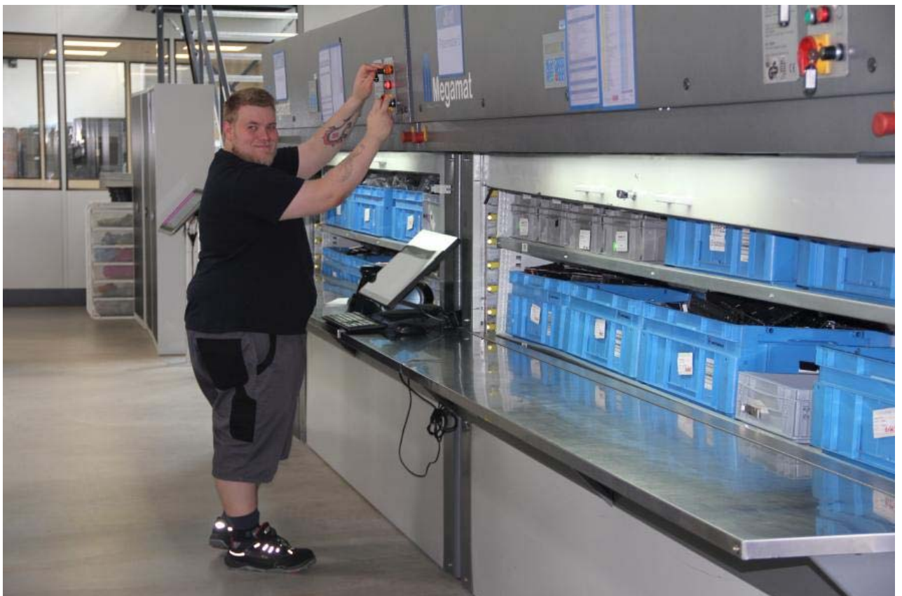
Im Ersatzteil-Lift sind häufig benötigte Teile schnell verfügbar.
