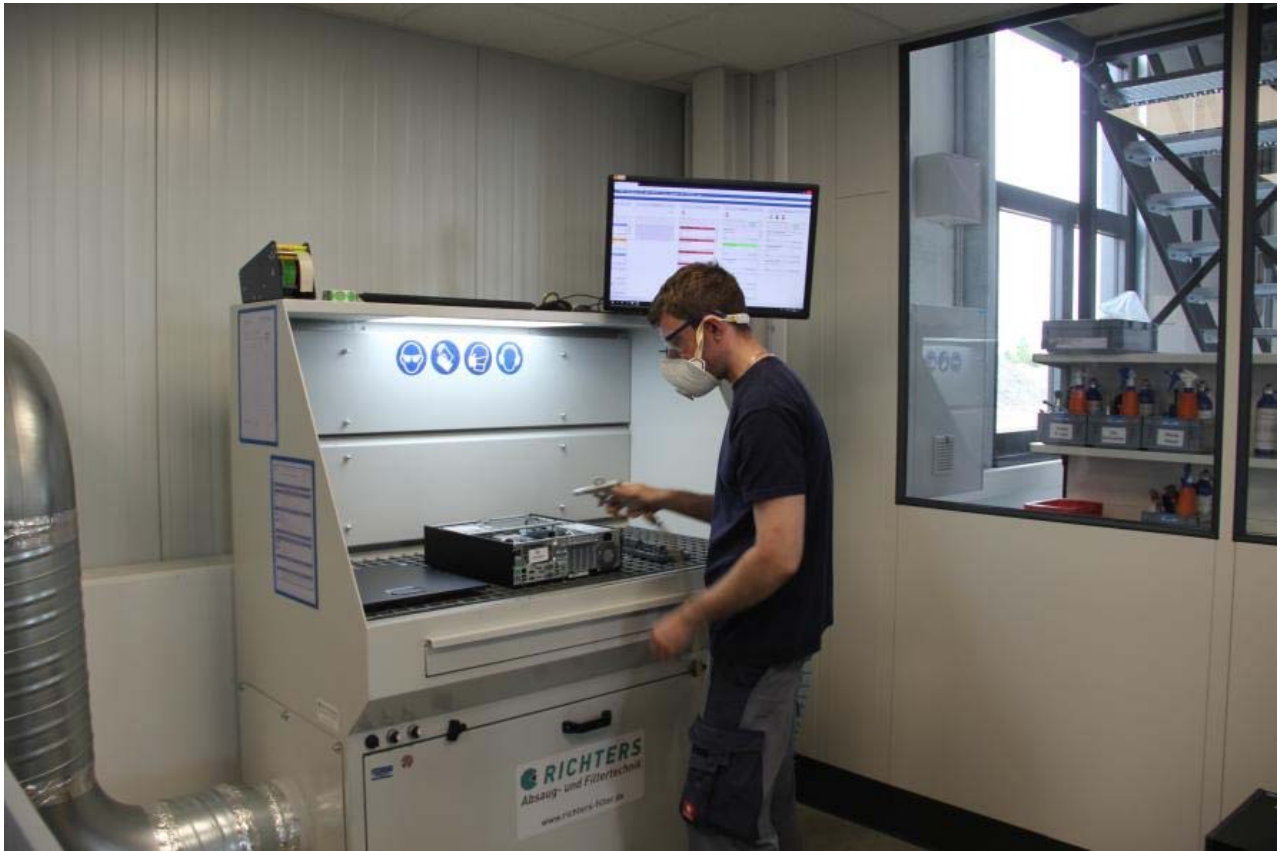
Der Staub wird mit einer eigens entwickelten Absauganlage abgeführt.
