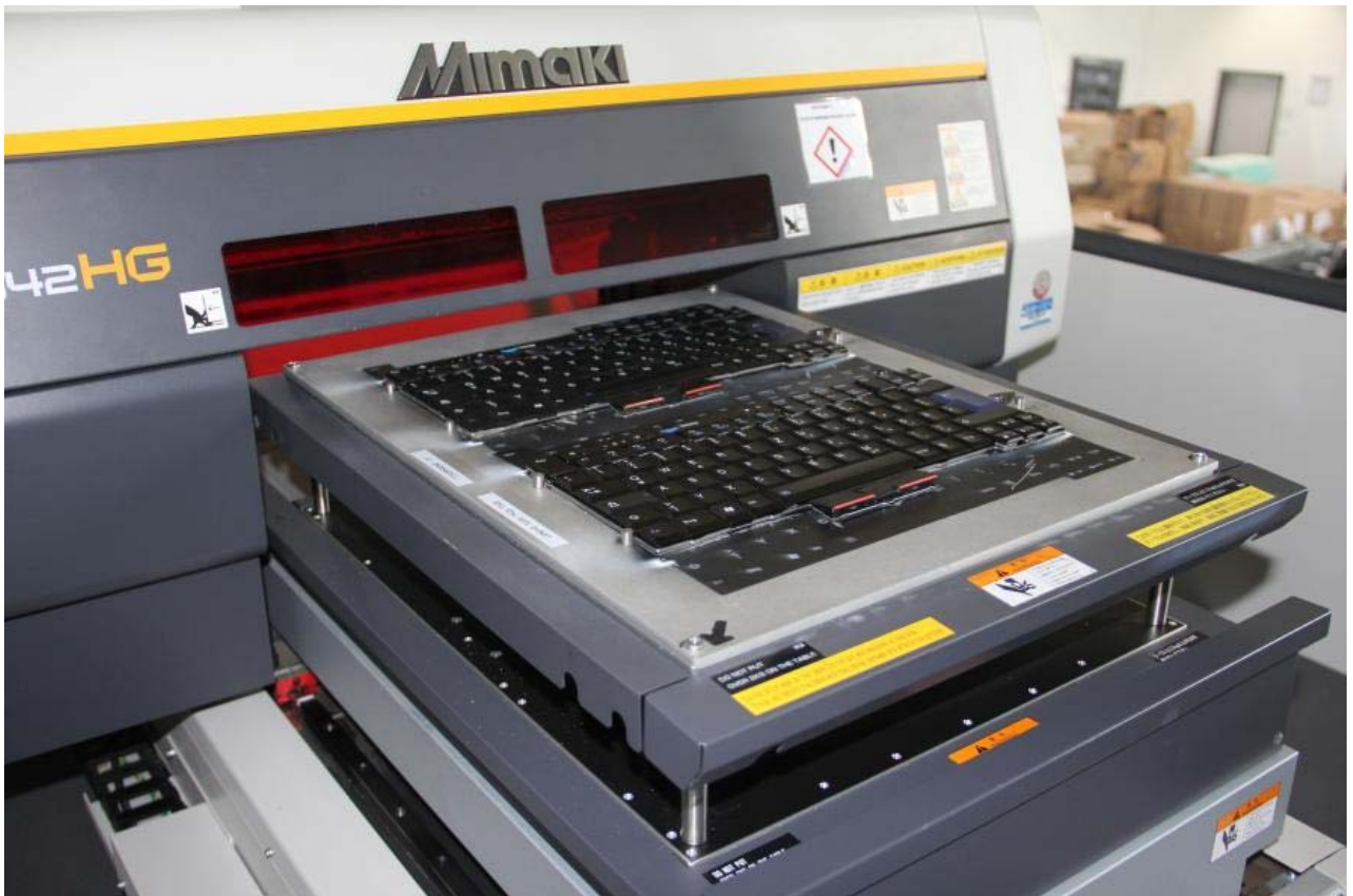
Gebrauchte und abgegriffene Tastaturen werden neu bedruckt oder mit anderem Tastatur-Layout versehen.
