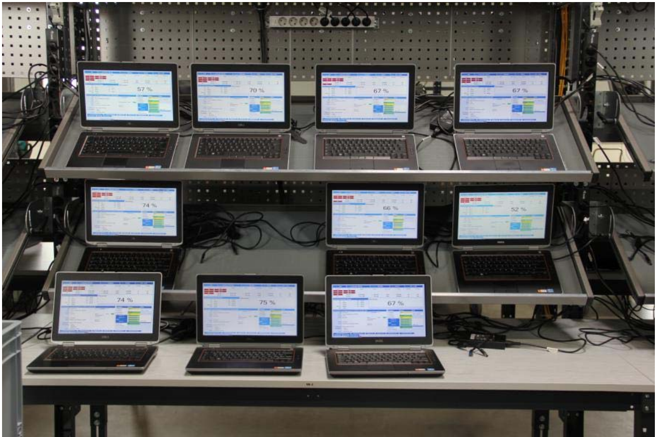
Nach der Betankung durchlaufen die Geräte mehrstündige Testläufe.
