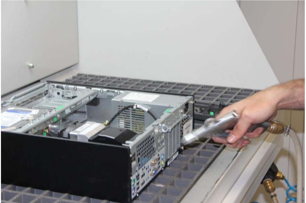
Während der bisherigen Betriebsdauer hat sich nicht nur äußerlich Schmutz abgelagert. Mit Druckluft wird Staub im Inneren der Gehäuse ausgeblasen.
